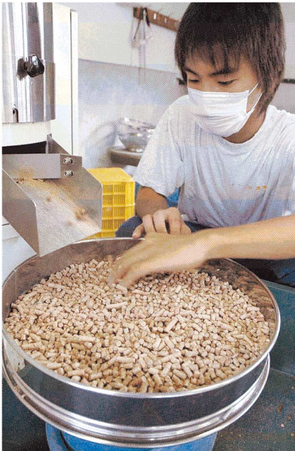
↑製造機から次々と排出されるペレット。木材実習で出たかんなくずが押し固められて燃料になる＝県立智頭農林高校 →鳥取県内の一般家庭に据え付けられたペレットストーブ。ペレットは化石燃料よりも二酸化炭素排出量が少なく、環境や体にやさしい燃料だ＝赤碕清掃提供
